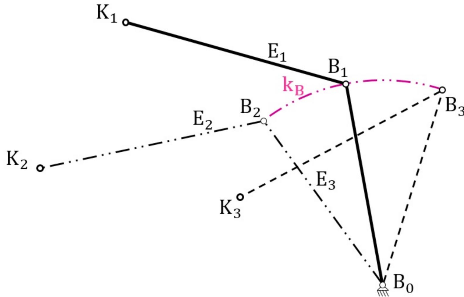
**Bild 6.9** Drei-Punktlagen-Synthese mit Vorgabe des gestellfesten Drehpunktes  $A_0$
