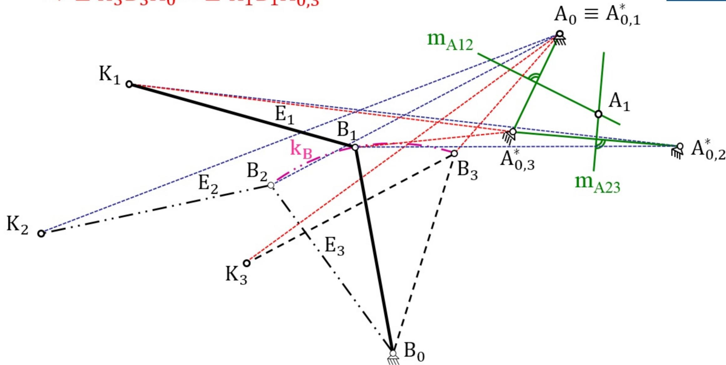
**Bild 6.9** Drei-Punktlagen-Synthese mit Vorgabe des gestellfesten Drehpunktes  $A_0$
