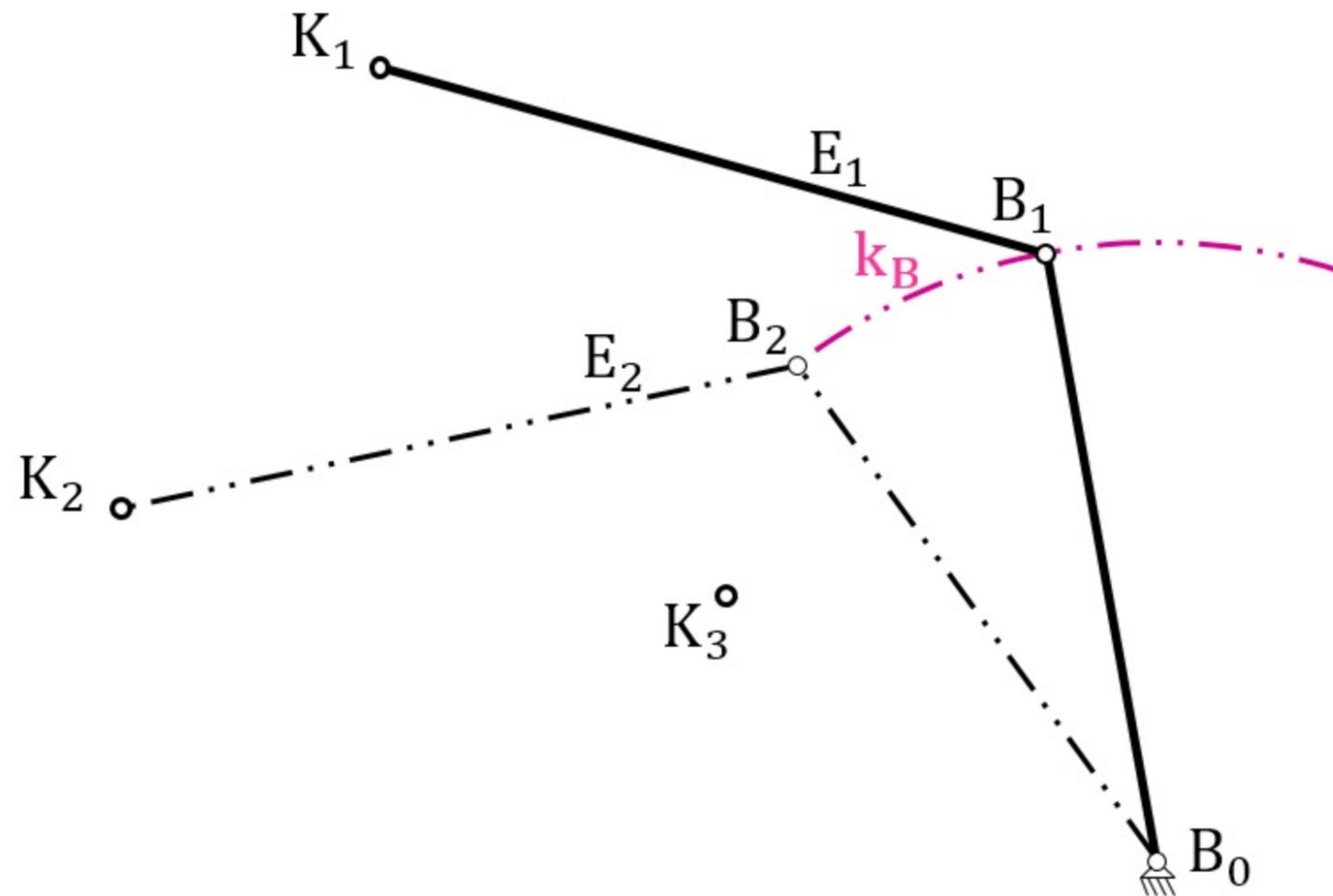
**Bild 6.9** Drei-Punktlagen-Synthese mit Vorgabe des gestellfesten Drehpunktes  $A_0$
