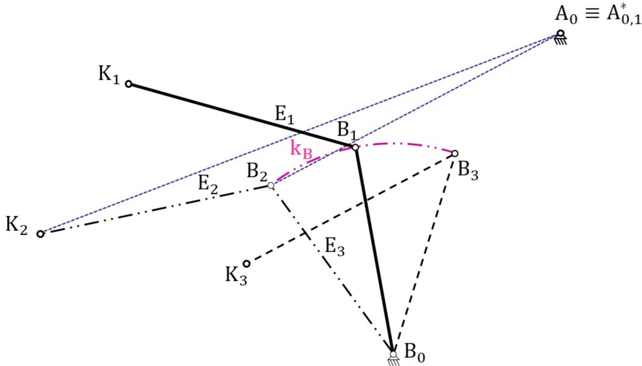
**Bild 6.9** Drei-Punktlagen-Synthese mit Vorgabe des gestellfesten Drehpunktes  $A_0$
