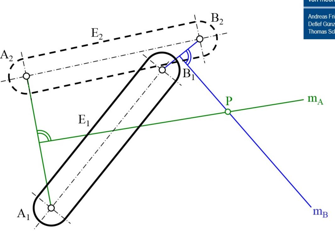
**Bild 6.4** Lösung mit 4-gliedrigem Koppelgetriebe Koppelgetriebe A<sub>0</sub>ABB<sub>0</sub>
