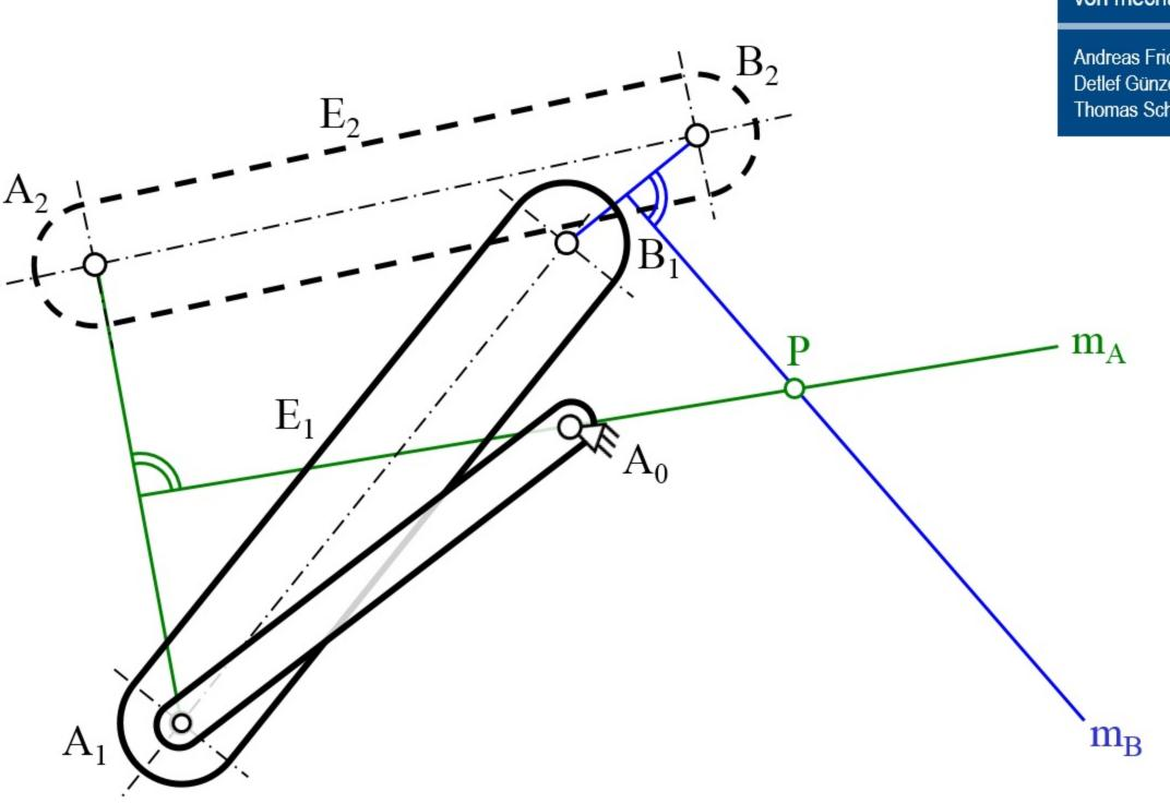
**Bild 6.4** Lösung mit 4-gliedrigem Koppelgetriebe Koppelgetriebe A<sub>0</sub>ABB<sub>0</sub>
