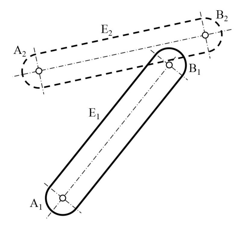
**Bild 6.4** Lösung mit 4-gliedrigem Koppelgetriebe Koppelgetriebe A<sub>0</sub>ABB<sub>0</sub>
