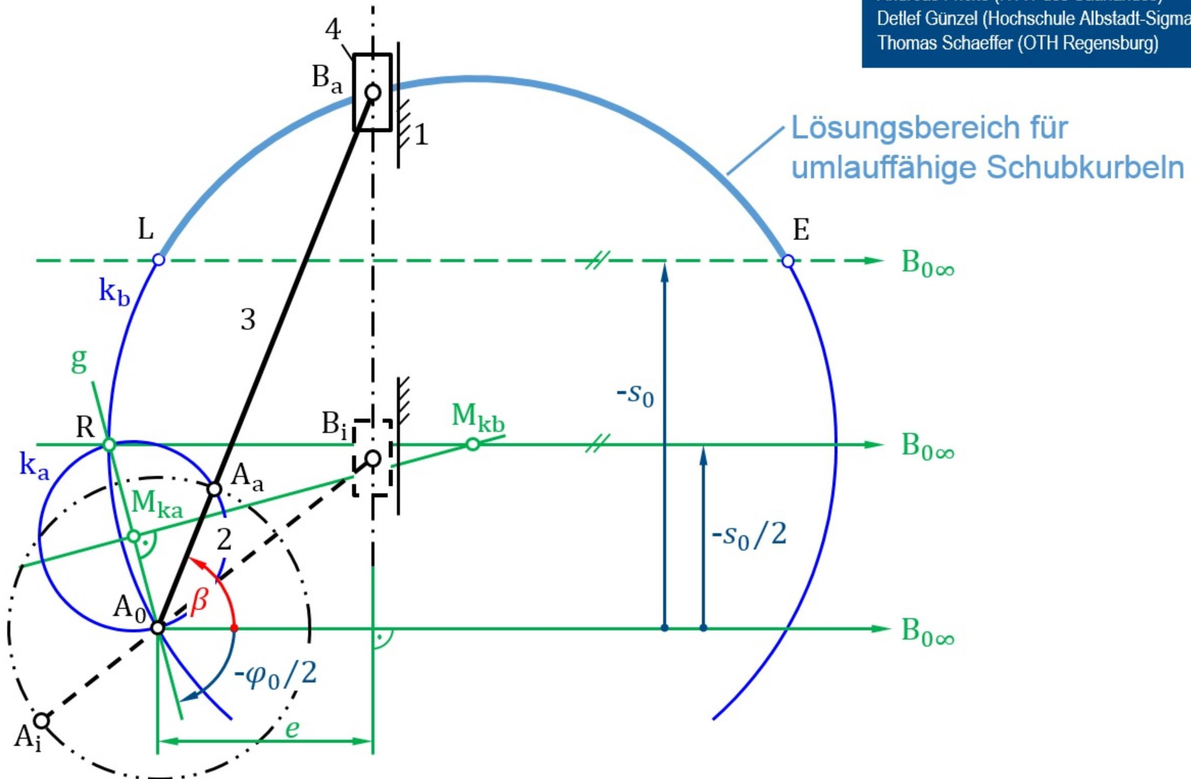
**Bild 6.27** Altsche Totlagenkonstruktion bei einer Schubkurbel
