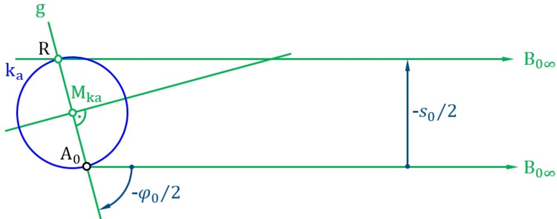
**Bild 6.27** Altsche Totlagenkonstruktion bei einer Schubkurbel
