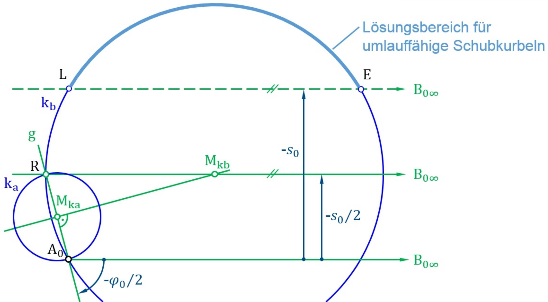
**Bild 6.27** Altsche Totlagenkonstruktion bei einer Schubkurbel
