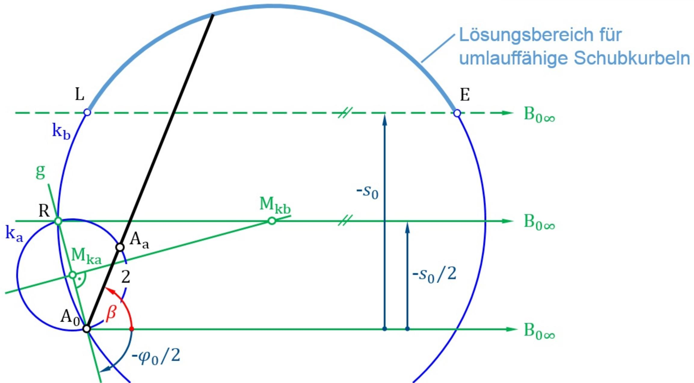
**Bild 6.27** Altsche Totlagenkonstruktion bei einer Schubkurbel
