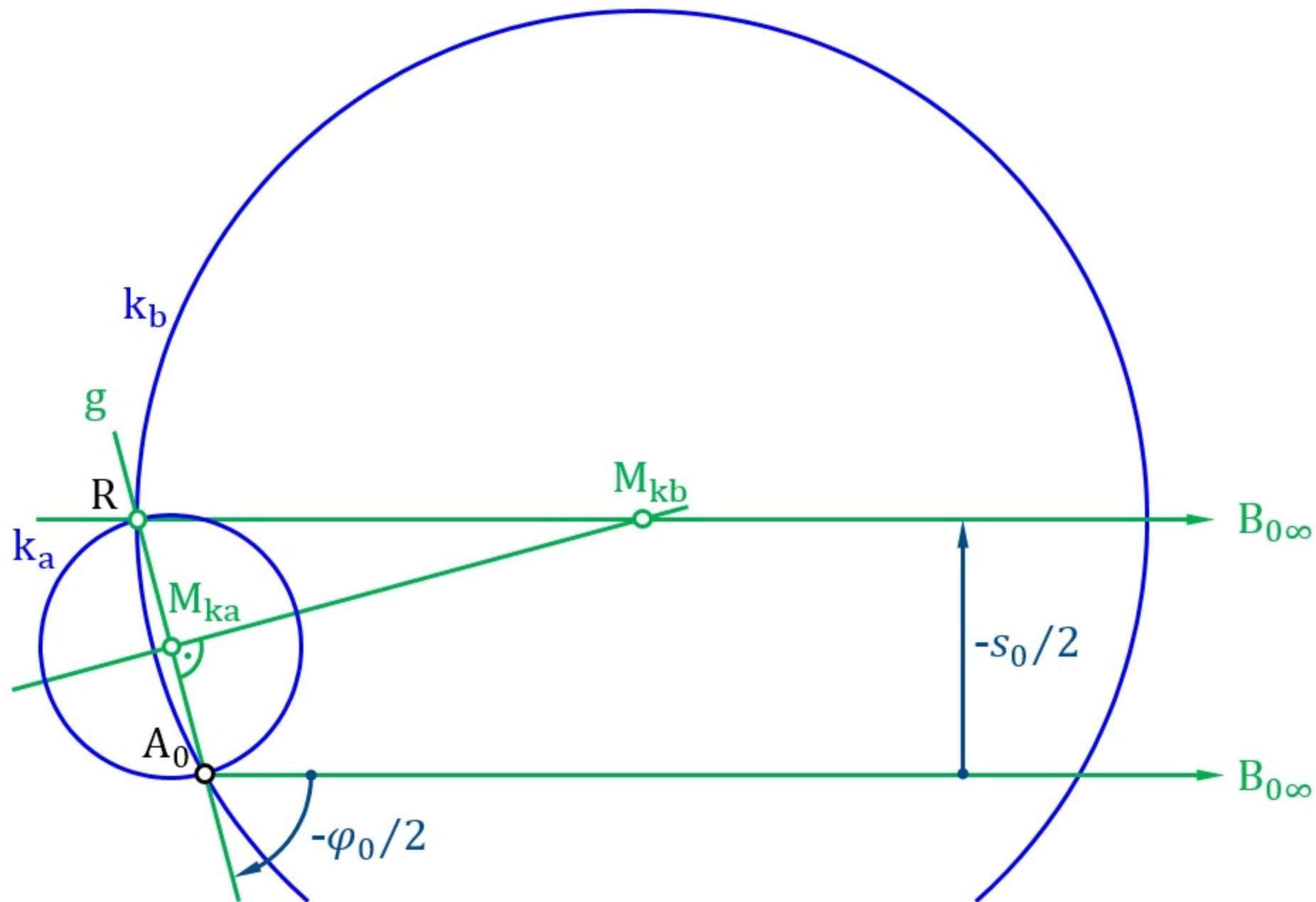
**Bild 6.27** Altsche Totlagenkonstruktion bei einer Schubkurbel
