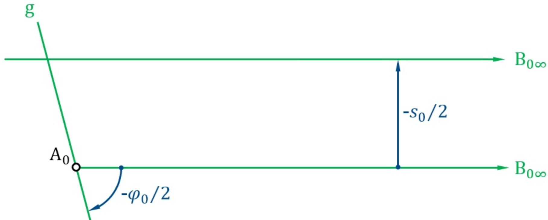
**Bild 6.27** Altsche Totlagenkonstruktion bei einer Schubkurbel
