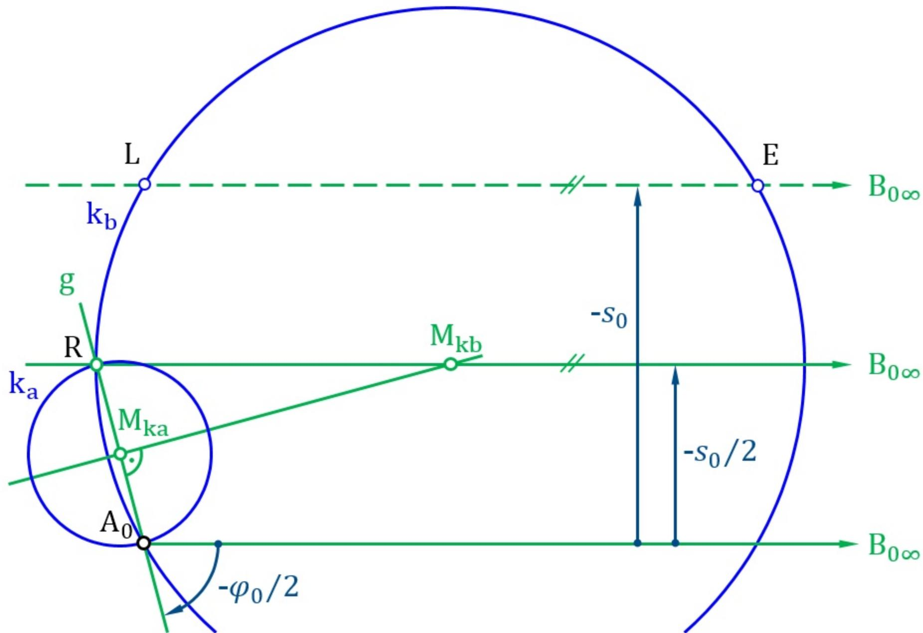
**Bild 6.27** Altsche Totlagenkonstruktion bei einer Schubkurbel
