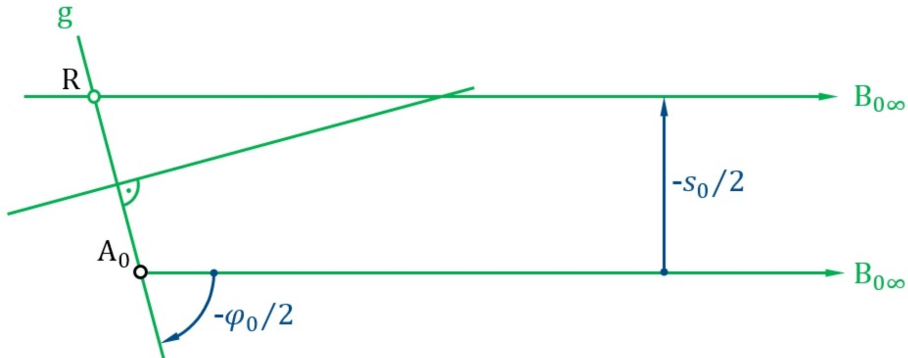
**Bild 6.27** Altsche Totlagenkonstruktion bei einer Schubkurbel
