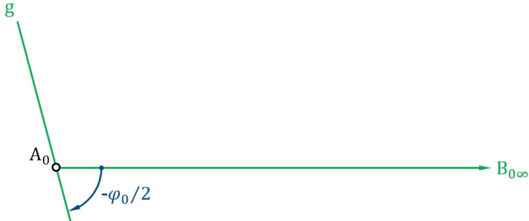
**Bild 6.27** Altsche Totlagenkonstruktion bei einer Schubkurbel
