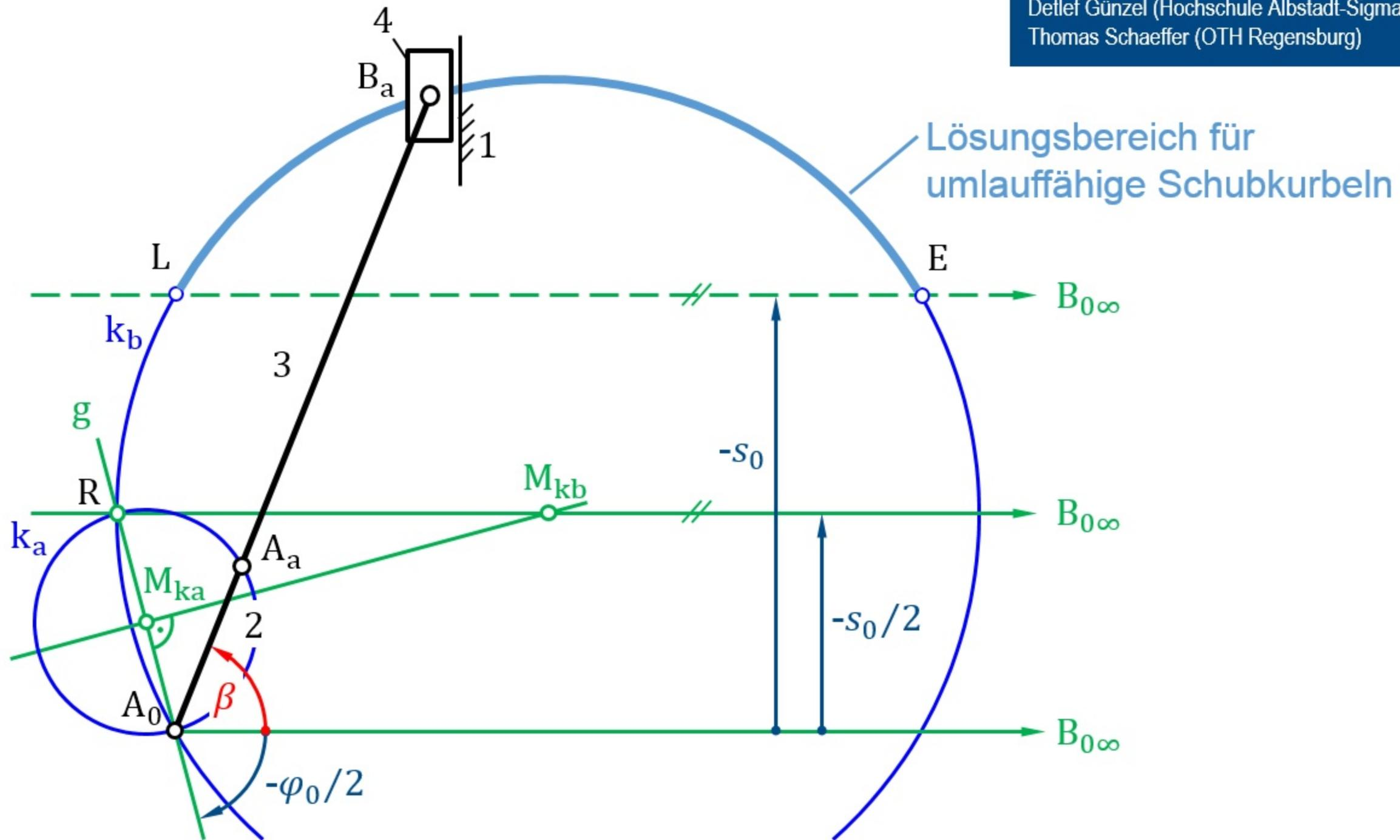
**Bild 6.27** Altsche Totlagenkonstruktion bei einer Schubkurbel
