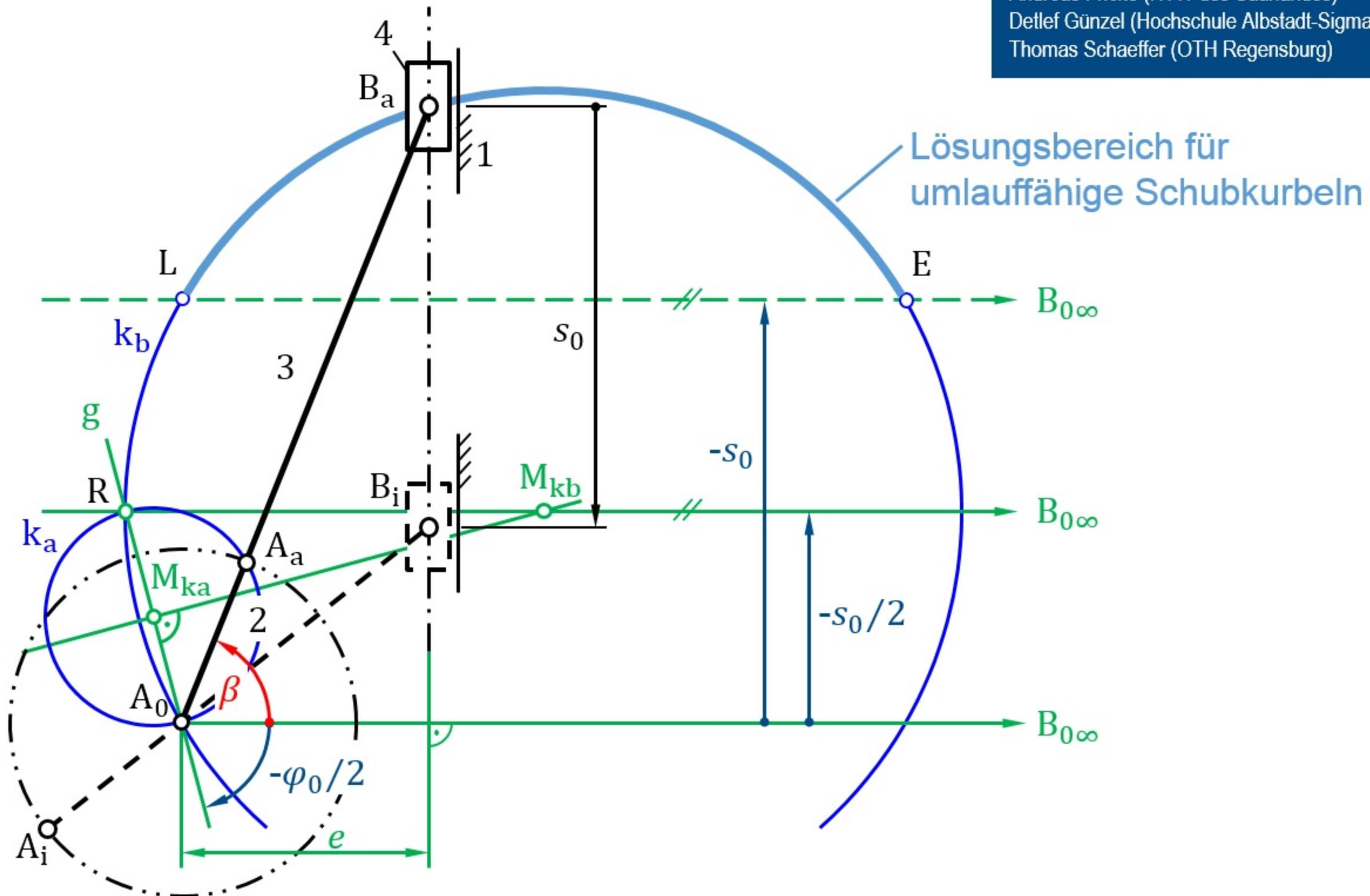
**Bild 6.27** Altsche Totlagenkonstruktion bei einer Schubkurbel
