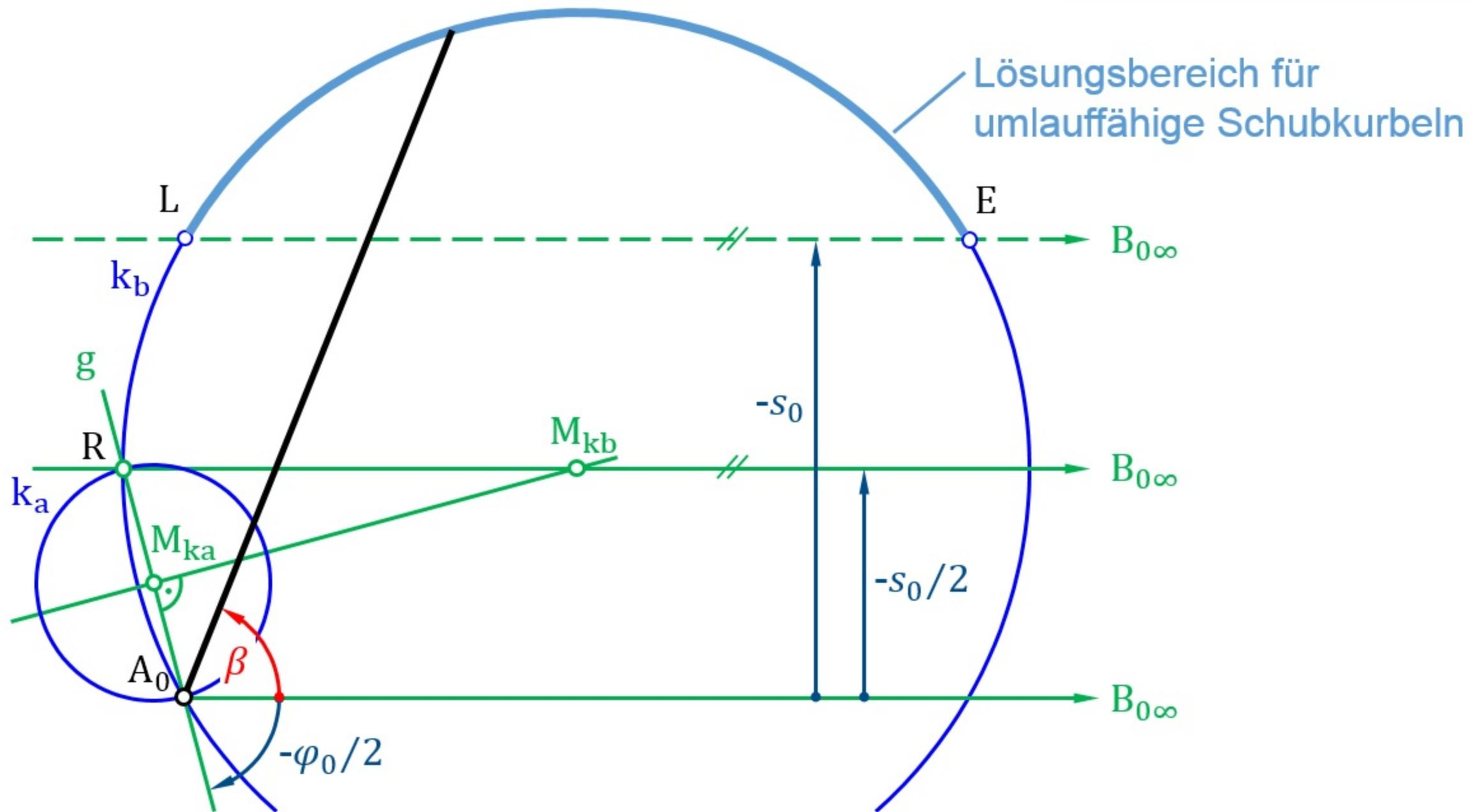
**Bild 6.27** Altsche Totlagenkonstruktion bei einer Schubkurbel
