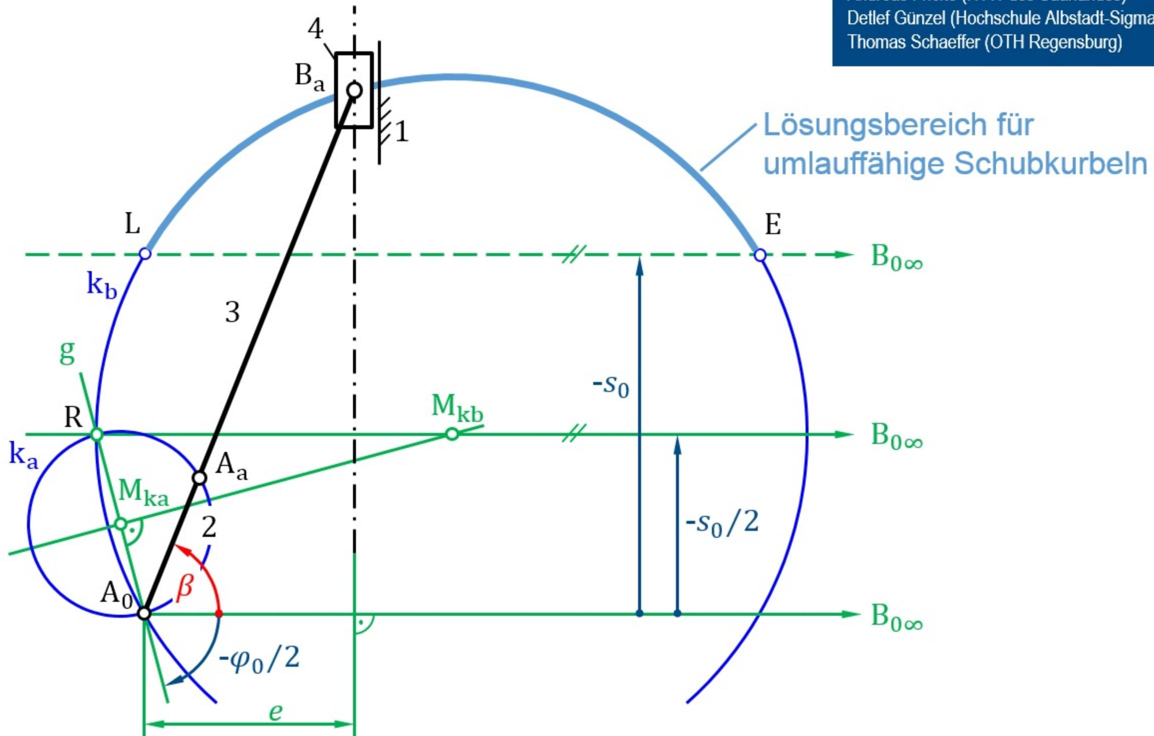
**Bild 6.27** Altsche Totlagenkonstruktion bei einer Schubkurbel
