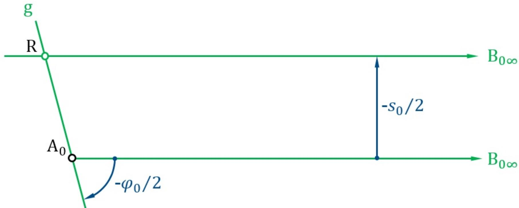
**Bild 6.27** Altsche Totlagenkonstruktion bei einer Schubkurbel
