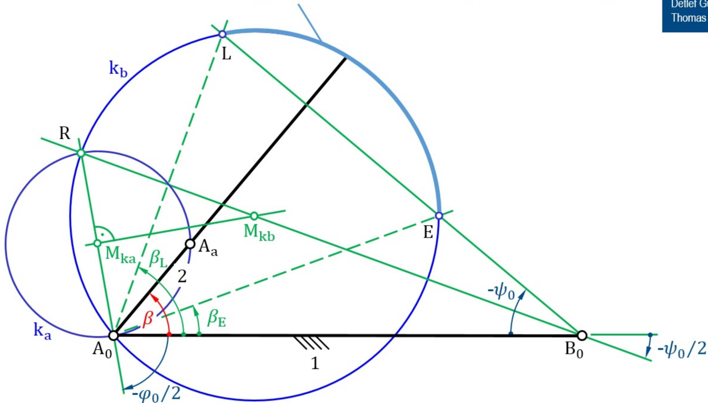
**Bild 6.22** Altsche Totlagenkonstruktion bei einer Kurbelschwinge
