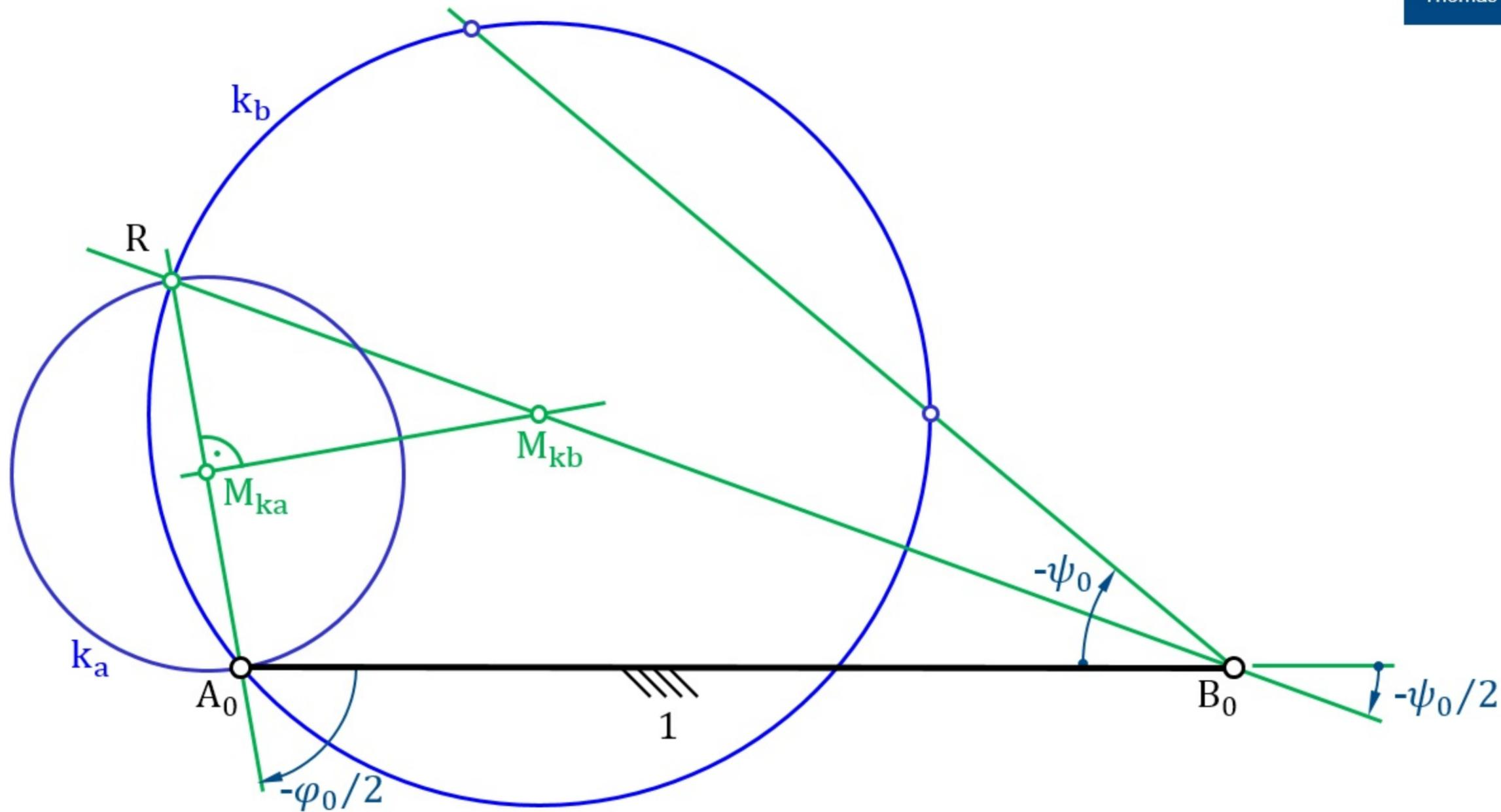
**Bild 6.22** Altsche Totlagenkonstruktion bei einer Kurbelschwinge
