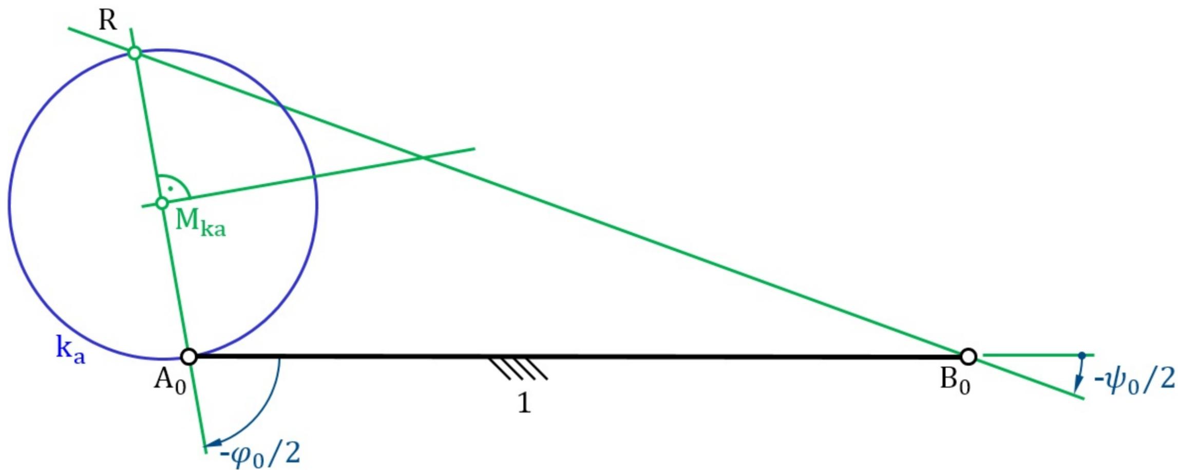
**Bild 6.22** Altsche Totlagenkonstruktion bei einer Kurbelschwinge
