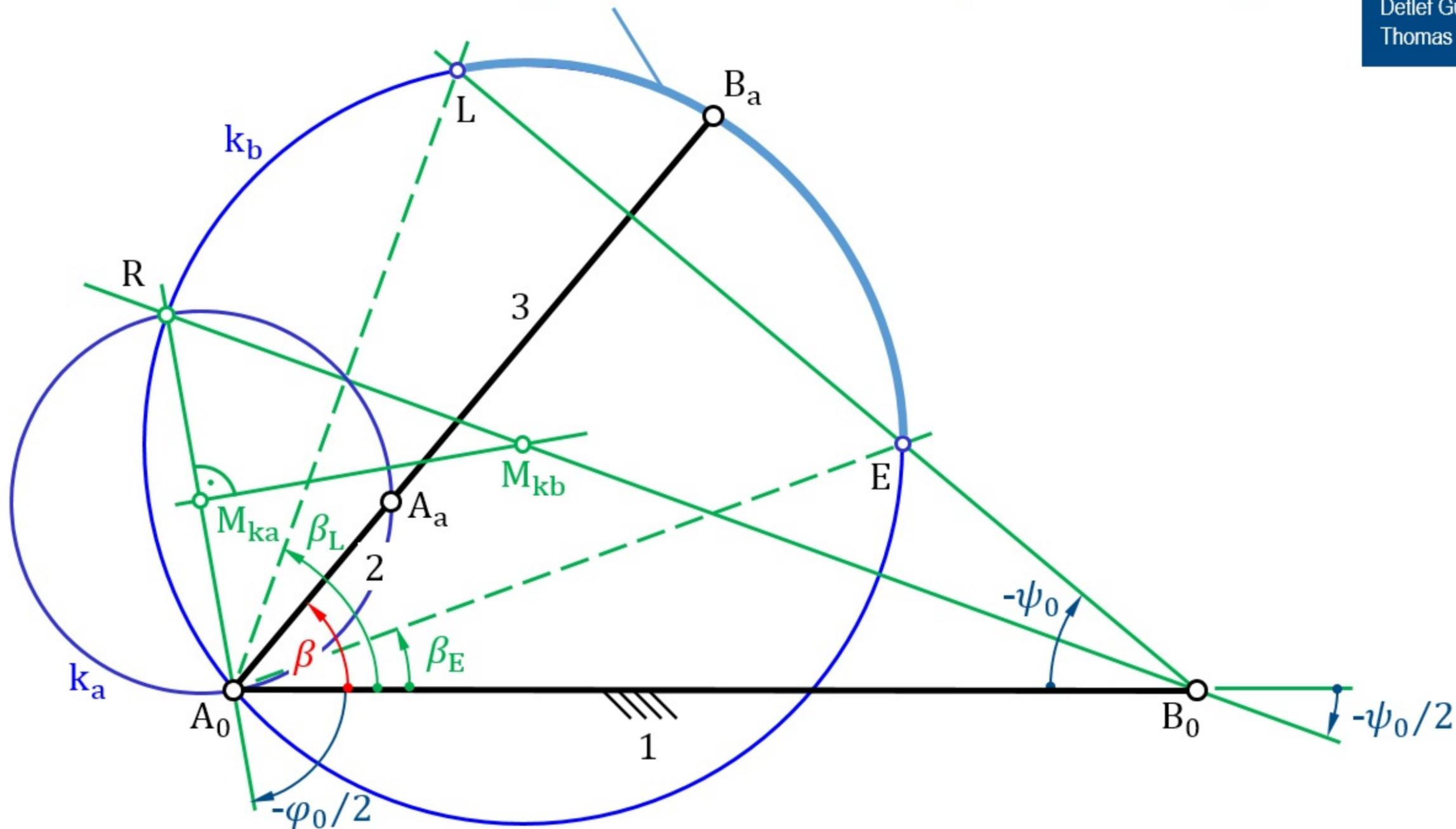
**Bild 6.22** Altsche Totlagenkonstruktion bei einer Kurbelschwinge
