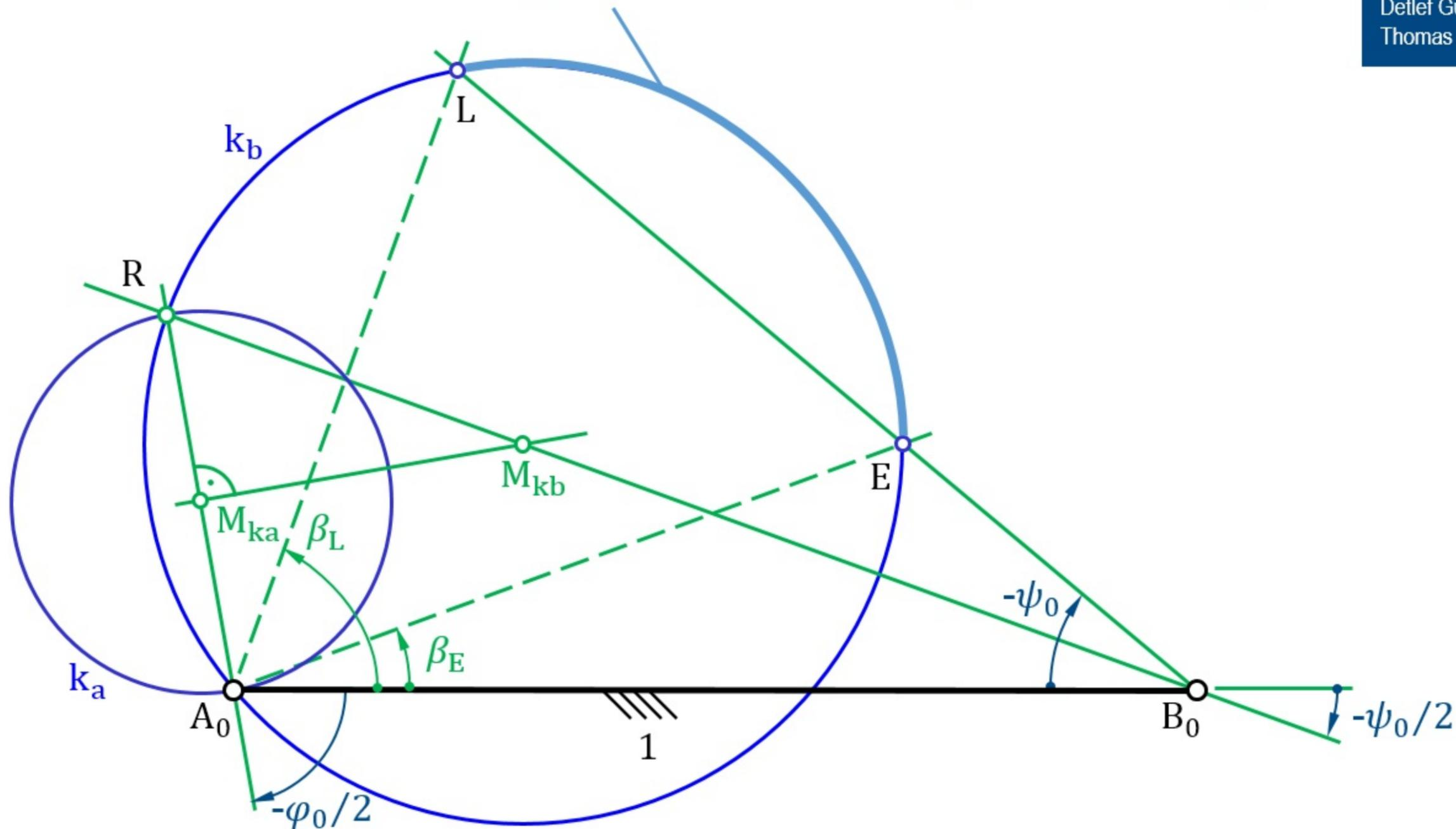
**Bild 6.22** Altsche Totlagenkonstruktion bei einer Kurbelschwinge
