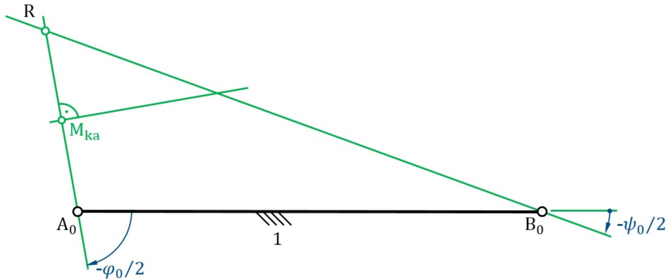
**Bild 6.22** Altsche Totlagenkonstruktion bei einer Kurbelschwinge
