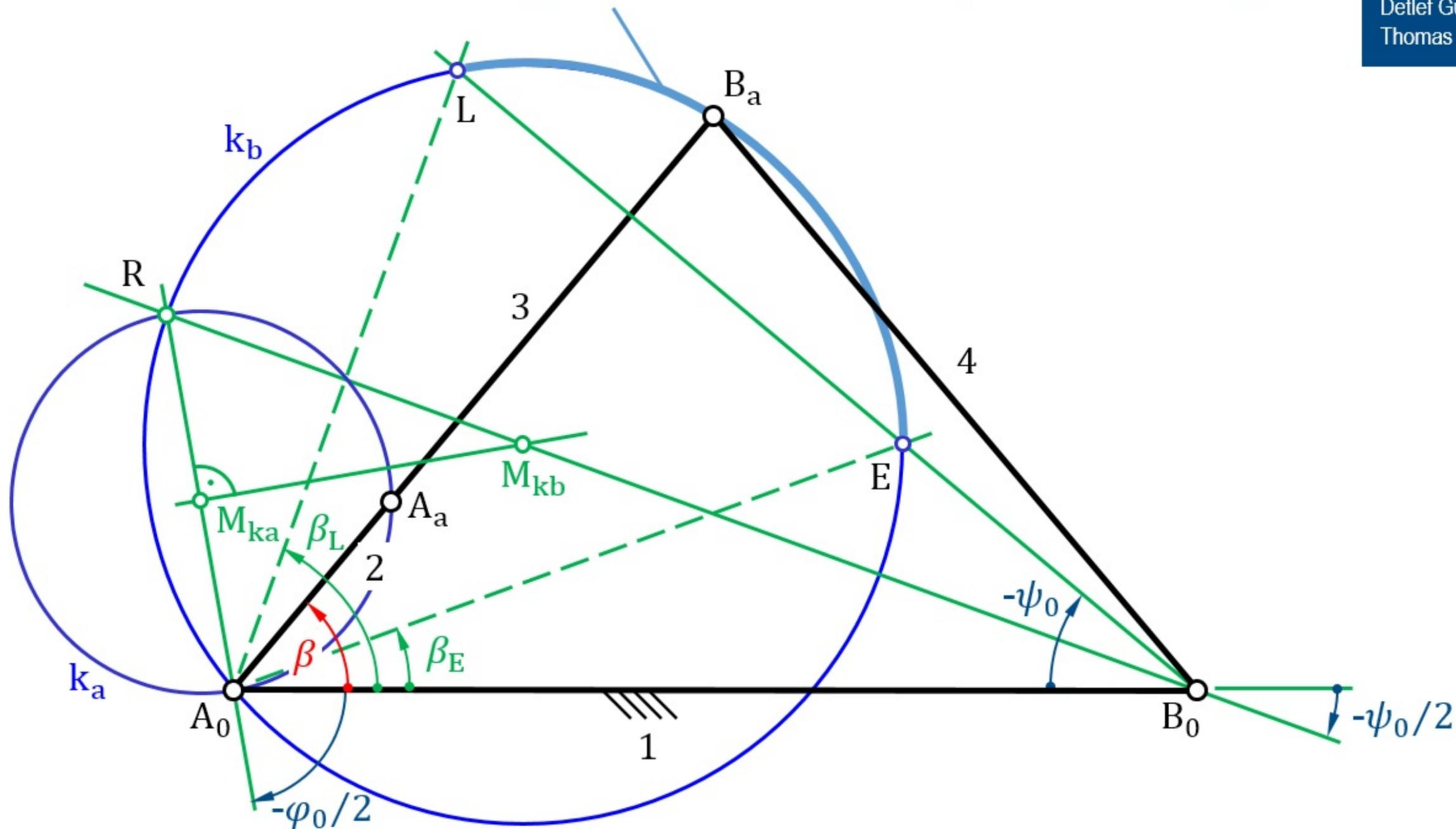
**Bild 6.22** Altsche Totlagenkonstruktion bei einer Kurbelschwinge
