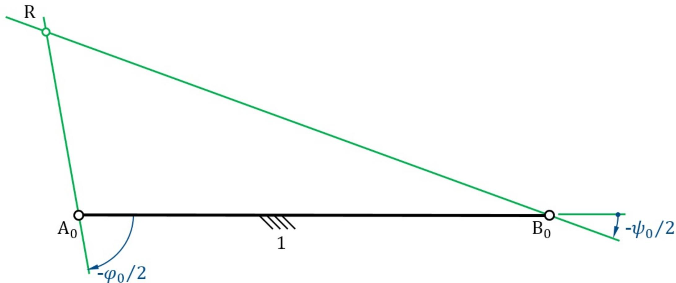
**Bild 6.22** Altsche Totlagenkonstruktion bei einer Kurbelschwinge
