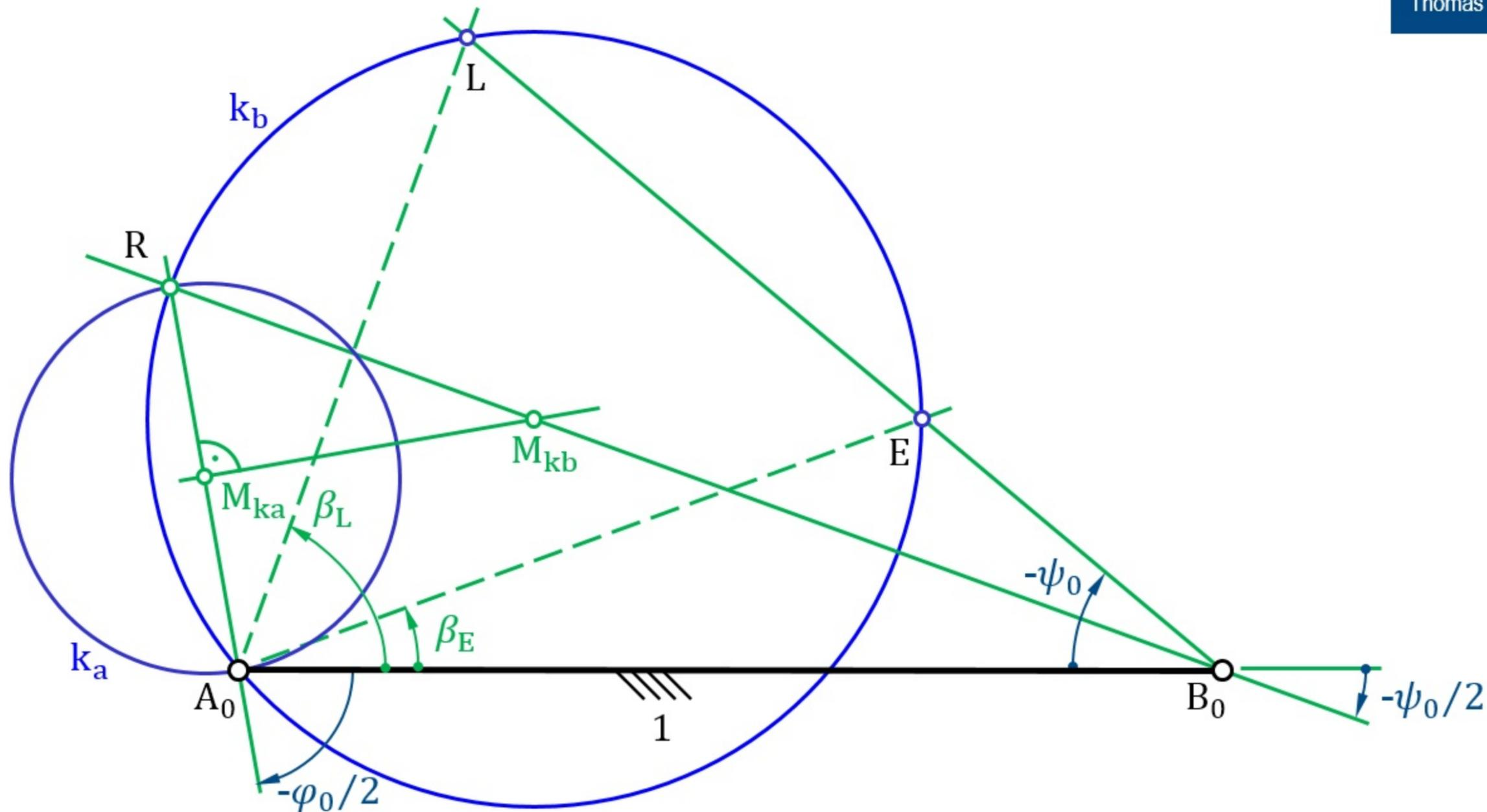
**Bild 6.22** Altsche Totlagenkonstruktion bei einer Kurbelschwinge
