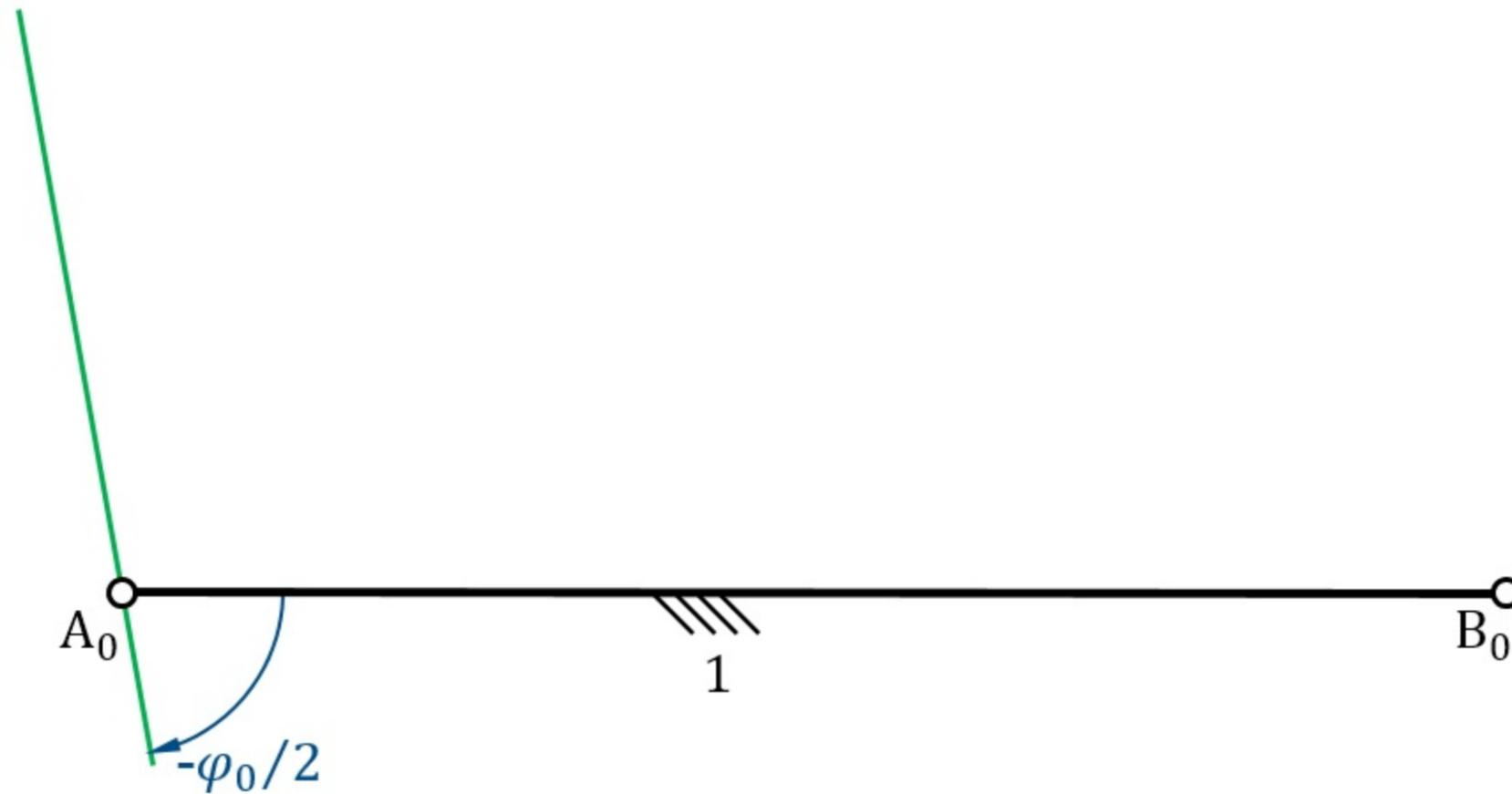
**Bild 6.22** Altsche Totlagenkonstruktion bei einer Kurbelschwinge
