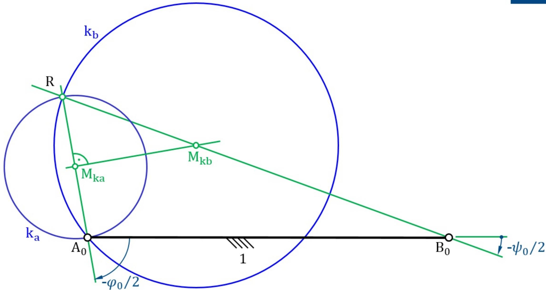
**Bild 6.22** Altsche Totlagenkonstruktion bei einer Kurbelschwinge
