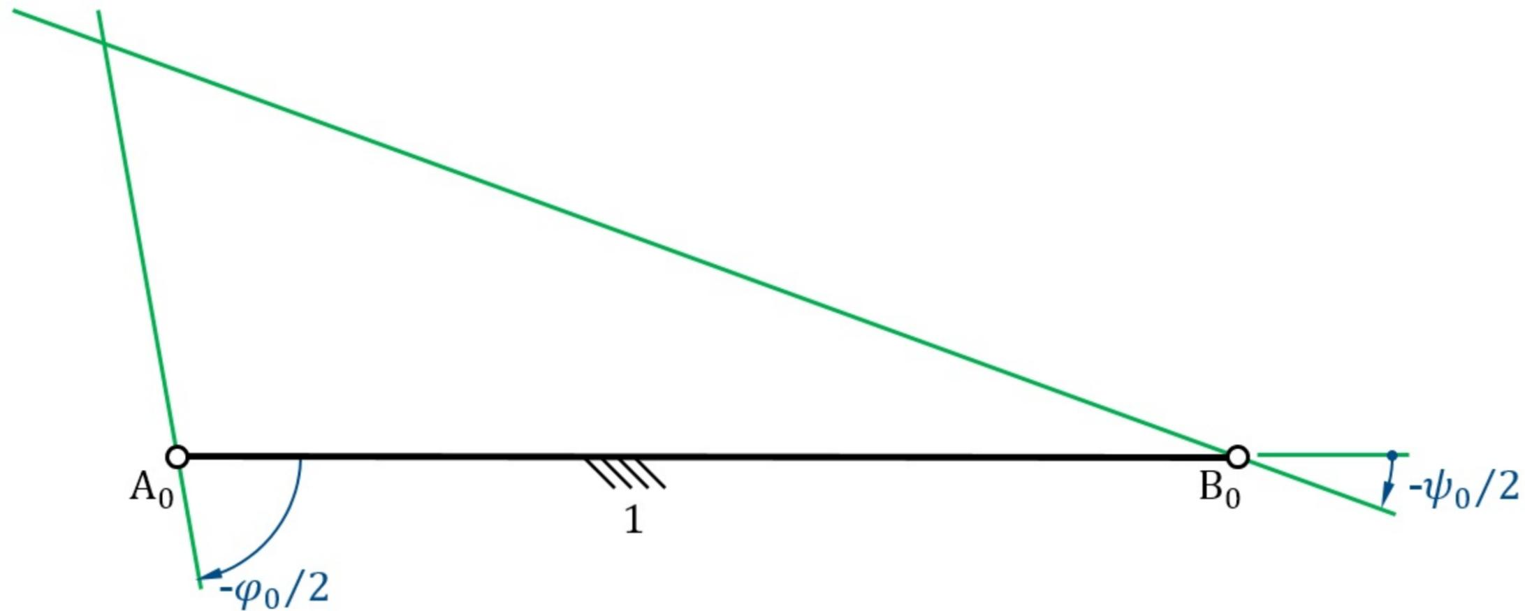
**Bild 6.22** Altsche Totlagenkonstruktion bei einer Kurbelschwinge
