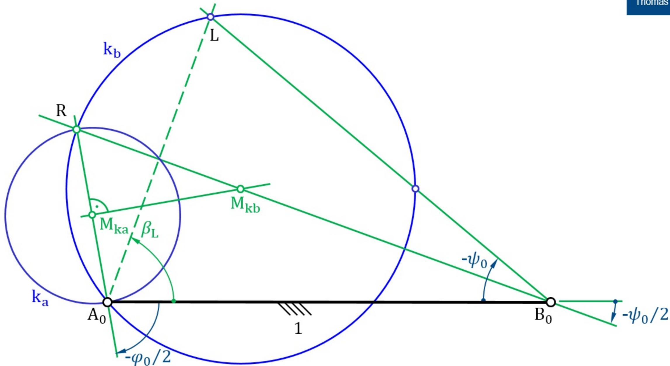
**Bild 6.22** Altsche Totlagenkonstruktion bei einer Kurbelschwinge
