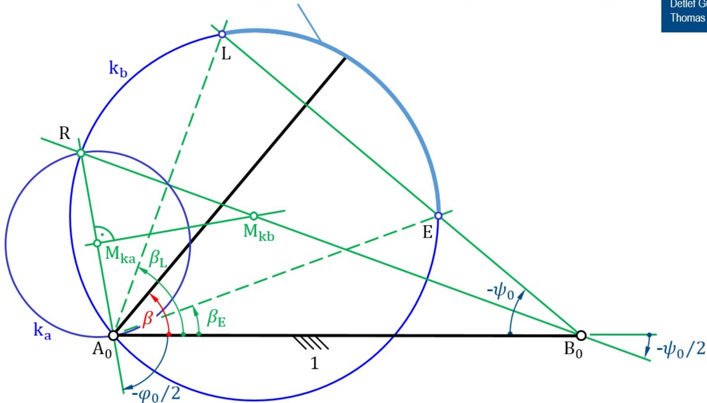
**Bild 6.22** Altsche Totlagenkonstruktion bei einer Kurbelschwinge
